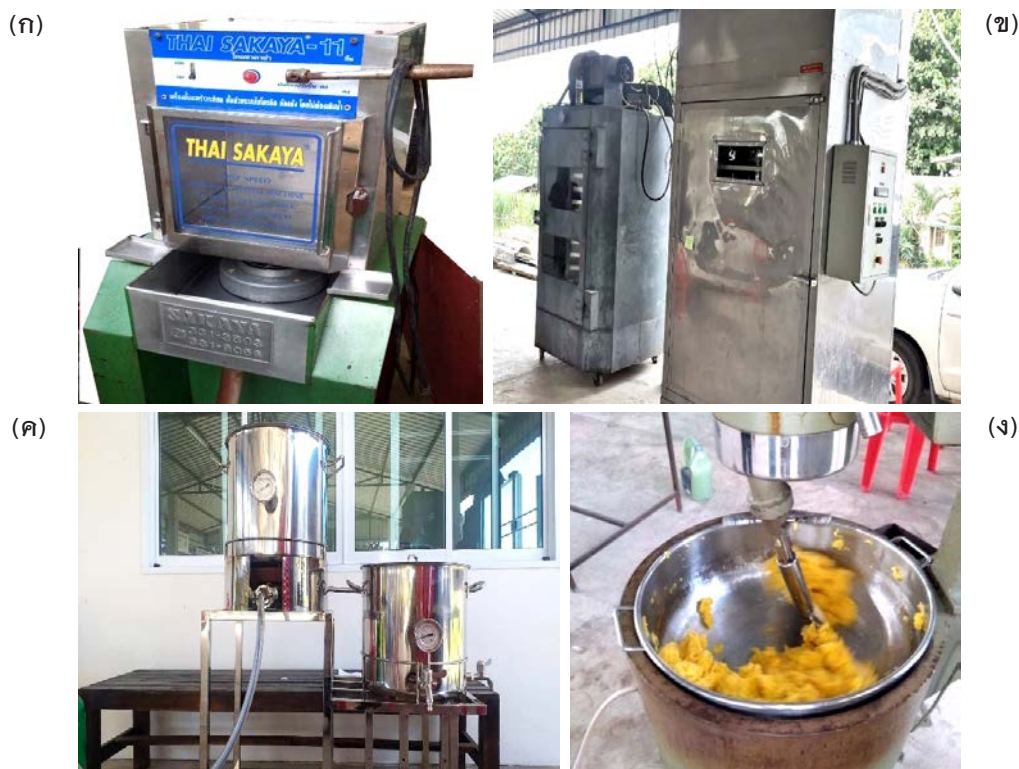
ภาพที่ 5 เครื่องจักรในการแปรรูปสับปะรดของชุมชนบ้านถ้ำพริก (ก) เครื่องบีบน้ำสับปะรด (ข) ตู้อบลมร้อน (ค) เครื่องพาสเจอร์ไรซ์ และ (ง) เครื่องกวนสับปะรด
